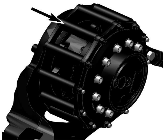
Рисунок 1 Система привода с одинарным выступом g06321178
